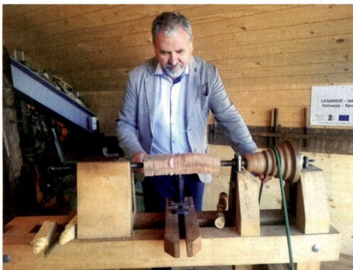
Jože Kos na ročni stružnici prikazuje njeno uporabo.
